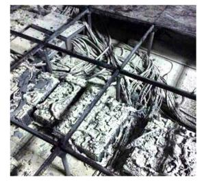
Figure 5 Exemple d'incendie de batteries
