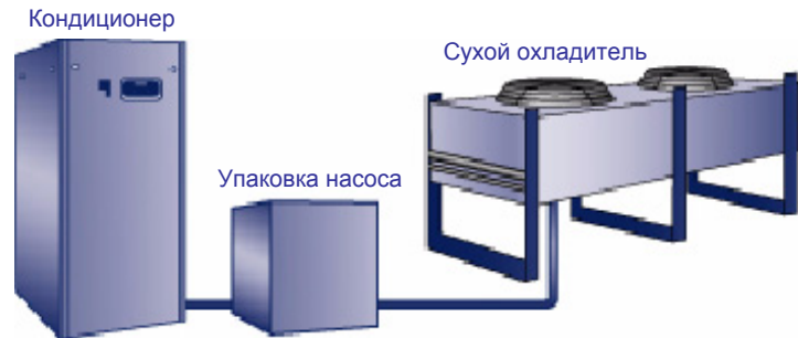
Рис. 7. Система охлаждения с помощью гликоля
