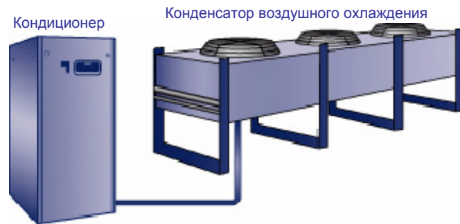
Рис. 5. Система охлаждения с помощью воздуха
