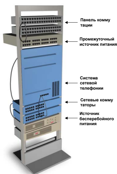
Рис. 3а - Промежуточный коммутационный щит (кабельный шкаф)
