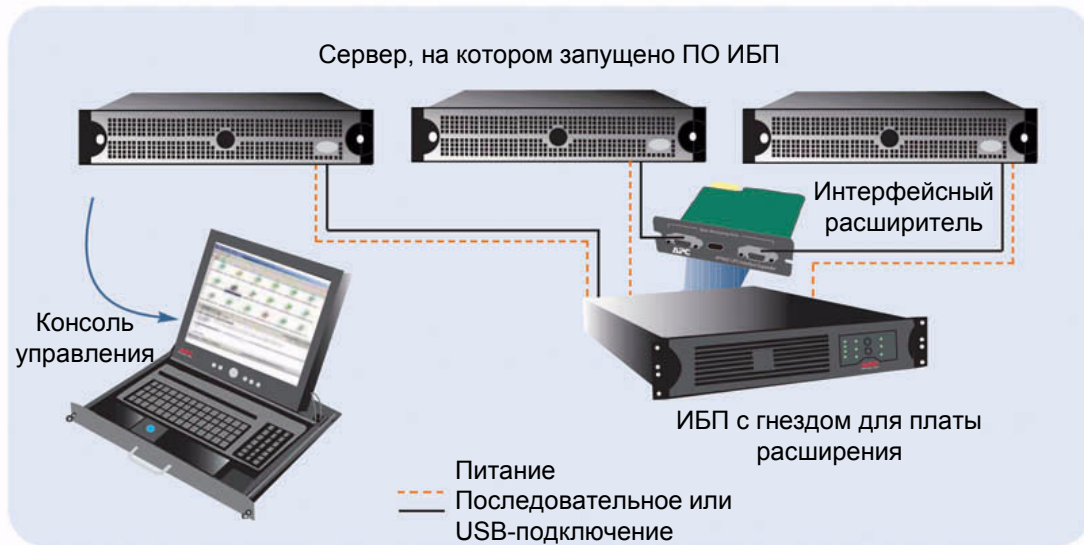
Рисунок 2 – Защита 2 - 3 компьютеров с помощью одного ИБП
