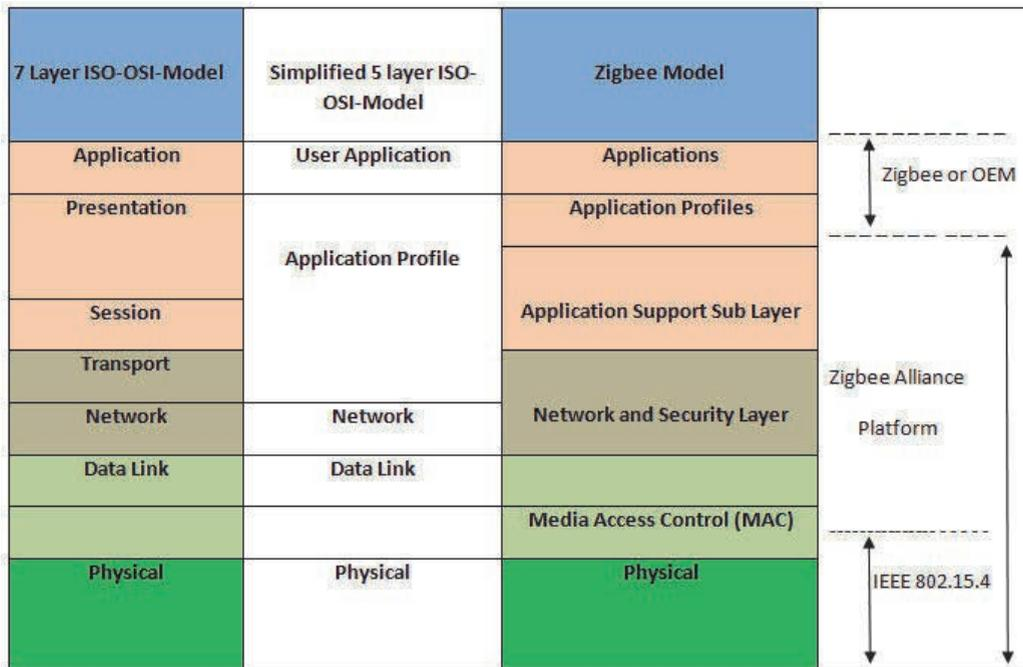
Figura 35 – Comparazione con il modello di riferimento ISO/OSI.
