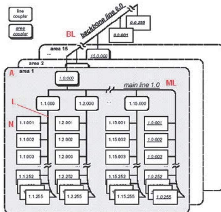
Figura 27 - Struttura di un sistema KNX
