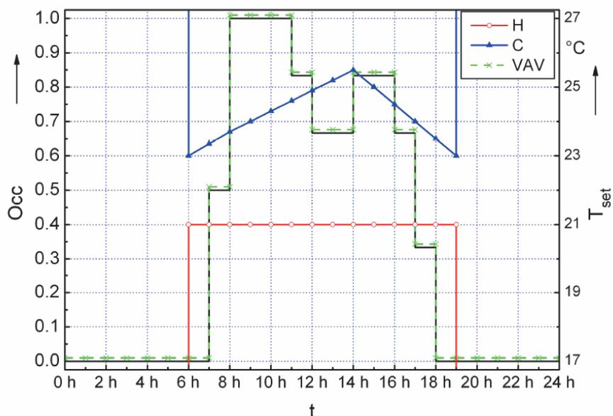
**Figura 11 - Profili di riscaldamento / raffreddamento in classe A (caso uffici)**
