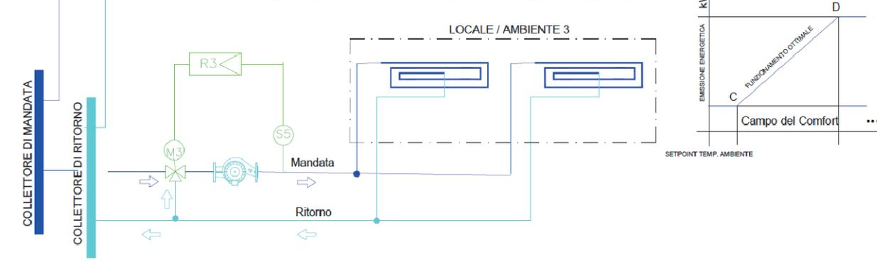
R 1/2/3    REGOLATORI ELETTRONICI: APPARECCHI COLLEGATI A UNA O PIU' SONDE DI TEMPERATURA
