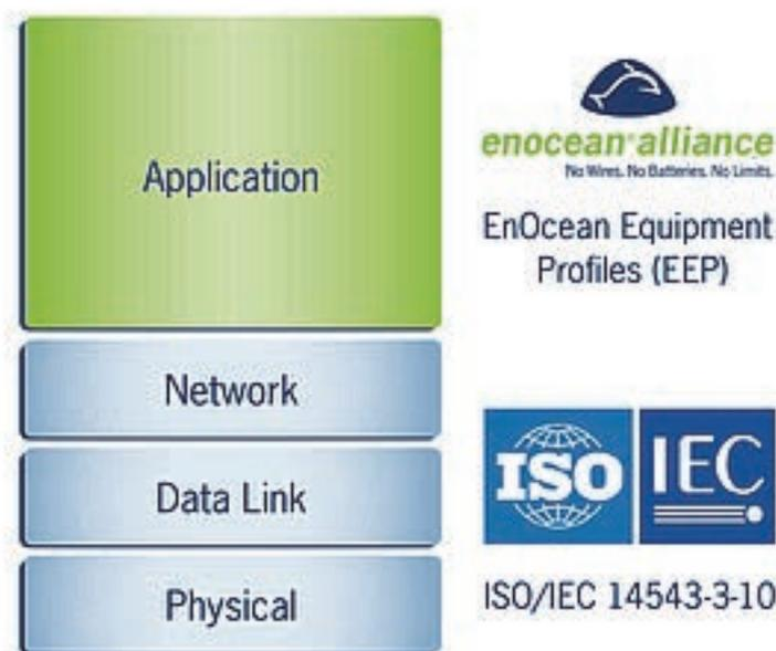
Figura 36 – Comparazione con il modello di riferimento ISO/OSI.
