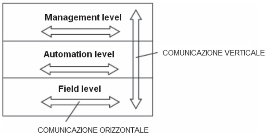
**Figura 24 – Livelli di un sistema di automazione edifici**
