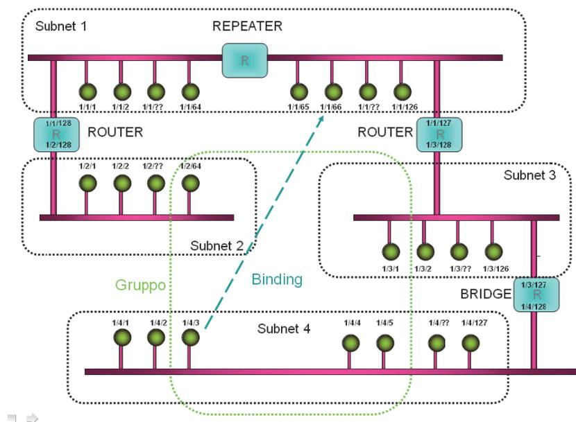
**Figura 32 – Struttura Domain / Subnet / Node**
