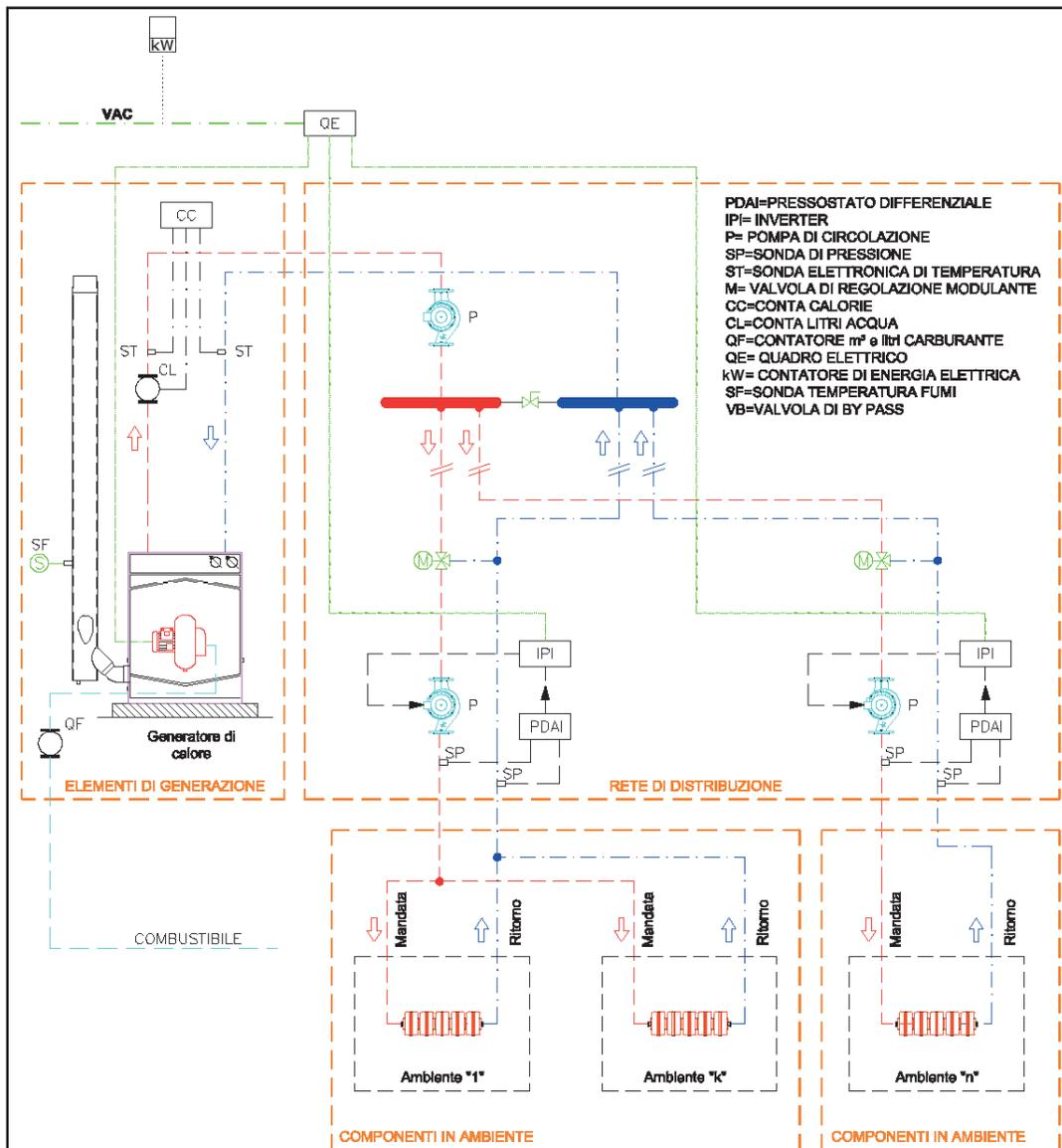
Figura 21 - Riscaldamento (H<sub>2</sub>O): schema generale di riferimento per più ambienti/zone serviti
