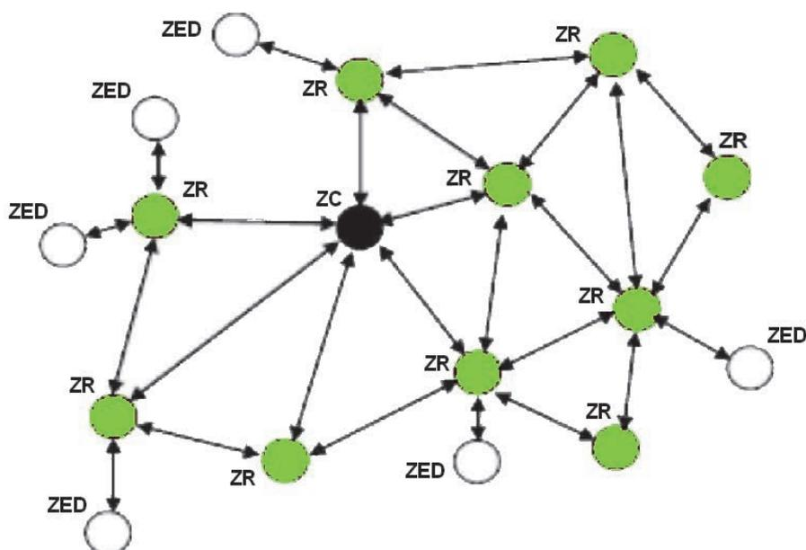
Figura 34 - Esempio di rete ZigBee di tipo Mesh.
