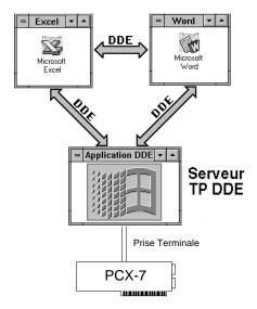
Le Serveur DDE UNITE Prise Terminale offre une interface logicielle qui convertit la messagerie UNI-TE en protocole DDE et inversement. Pour une application Windows, il prolonge le protocole DDE jusqu'aux équipements raccordés à un réseau FIPWAY.
