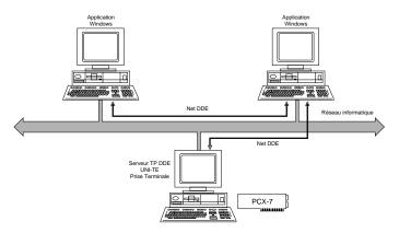
Dans cet exemple, deux réseaux sont mis en oeuvre. L'avantage de cette architecture est de répartir les flux d'informations entre le bus industriel et un réseau informatique.
