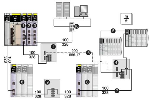
1 140CRP31200 remote I/O head module
