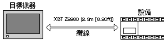
圖 19 XBT GK 系列、XBT GK 系列、HMIGTO 系列、HMISTO 系列、HMISTU 系列 RS 485
