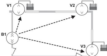
Os 3 módulos combináveis de estores V1, V2, V3, (receptores) são instalados para o comando local. O botão de pressão com bateria B1 (emissor) é usado como comando centralizado; pode ser fixado em qualquer parede. B1 é associado a V1, V2, V3 através de um endereçamento simples.
