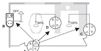
Dans cet exemple, le poussoir A alimenté par pile comprend les scénarios d'éclairage préférés. Lorsque la famille veut préparer un repas, une pression sur le symbole du scénario « Préparation du repas » :
