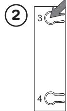
Dentro de 5 segundos, seleccione el par de teclas que desea usar: presione 3 ó 4 para seleccionar el lado izquierdo (es igualmente válido si presiona 3 ó 4), o presione 1 ó 2 para seleccionar el lado derecho.
