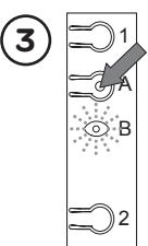
Pressionar botão de programação A uma vez. O LED acende-se VERMELHO intermitente (após 5 segundos no módulo combinável).
