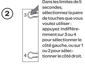
Dans les limites de 5 secondes, sélectionnez la paire de touches que vous voulez utiliser : appuyez indifféremment sur 3 ou 4 pour sélectionner le côté gauche, ou sur 1 ou 2 pour sélectionner le côté droit. La LED B clignote en ROUGE.
