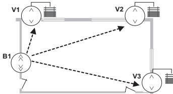
Les 3 modules combinés pour volets roulants V1, V2, V3 (récepteurs) sont installés à la place des commandes existantes. Le poussoir B1 alimenté par pile (émetteur) est utilisé pour la commande centralisée ; il peut être fixé n'importe où sur le mur. B1 est associé à V1, V2, V3 par un lien simple.
