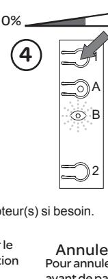
Si le récepteur a une fonction variateur, réglez le niveau souhaité avec les boutons 1 ou 2. Si le récepteur a une fonction relais, sélectionnez l'état souhaité (on/off) en appuyant sur les mêmes boutons. La LED B s'allume en rouge pendant 5 s, puis clignote en vert.
