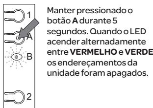
Mantendo pressionado o botão A durante 5 segundos. Quando o LED acender alternadamente entre VERMELHO e VERDE, os endereçamentos da unidade foram apagados.
