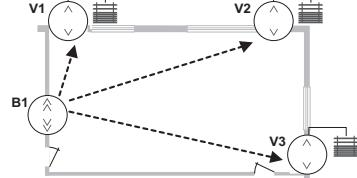
Los 3 receptores RF para persianas V1, V2, V3, (receptores) están instalados en lugar de los controles existentes.
