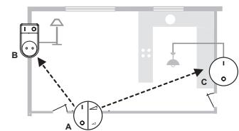
De door een batterij gevoede drukknop **A** kan de volgende functies sturen:
