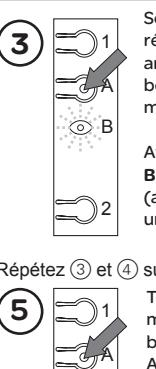
Sélectionnez le récepteur en appuyant une fois sur le bouton de programmation A. Attendez que la LED B clignote en VERT (au bout de 5 s avec un module combiné).
