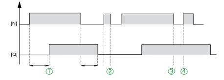
① : ON delay, ② : OFF delay, ③ : t < ON delay, ④ : t < OFF delay
