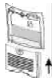
e. Deslice la tapa del compartimento de la batería nuevamente en su posición.
