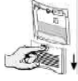
b. Deslice hacia abajo la tapa del compartimento de la batería.
