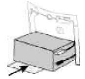
d. Deslice la batería nuevamente en posición. Evite atrapar los cables.
