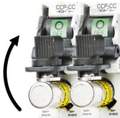
Figure / Figura / Figure 6 : Opening Fused Disconnect to Replace Fuses / Cómo abrir el desconectador fusible para reemplazar los fusibles / Ouverture du sectionneur à fusible pour remplacer des fusibles
