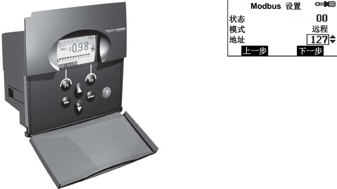
图 11: PFC 中的 Modbus 设置
