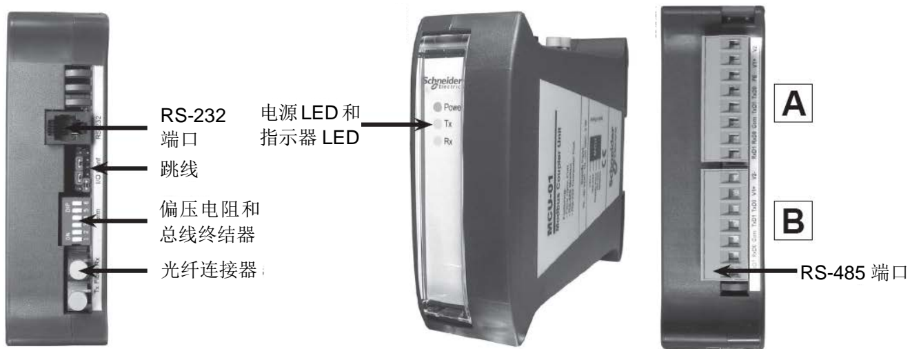
图 6: MCU 中的接线端子和指示器
