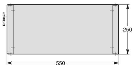
Fig. 8: base para fijación de los cofrets en el suelo ref. 52671.
