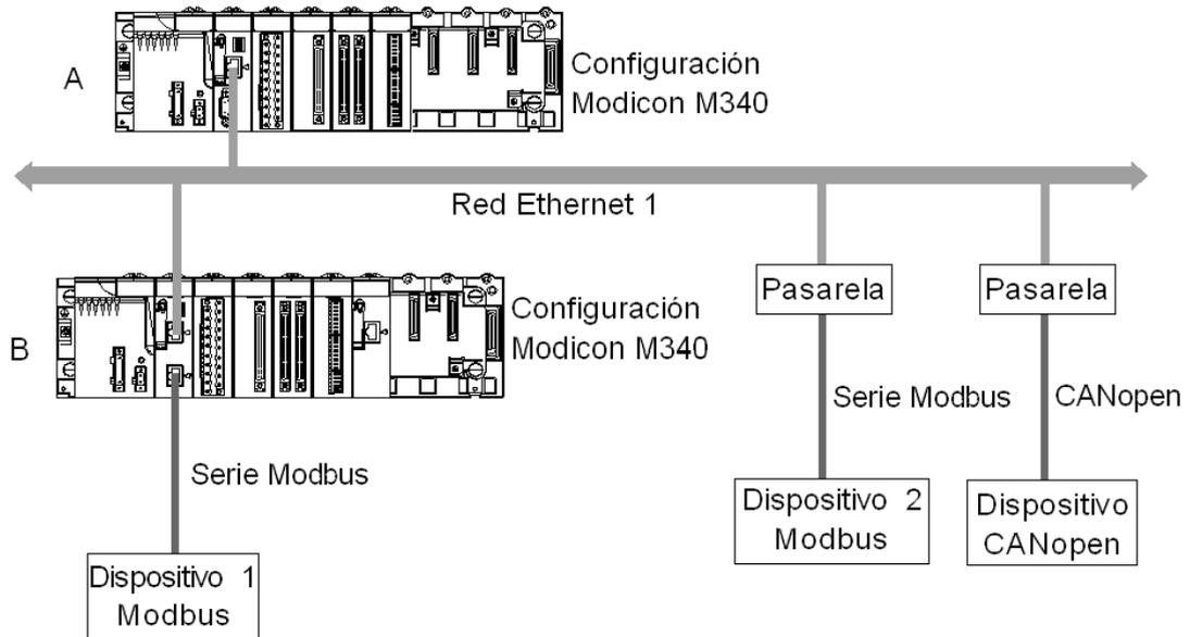
En el diagrama anterior aparecen dos configuraciones Modicon M340 llamadas A y B. La configuración B está conectada directamente al dispositivo Modbus 1 través de un canal de comunicación Modbus.
