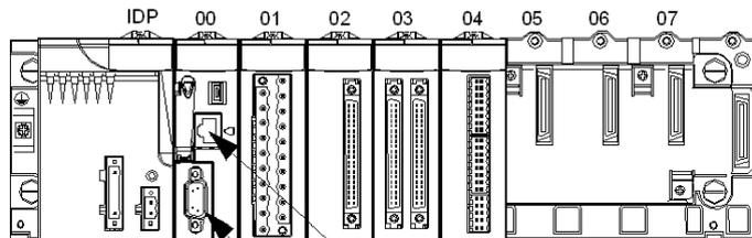
Bastidor 0. Módulo 0. Canal 3: Puerto Ethernet
