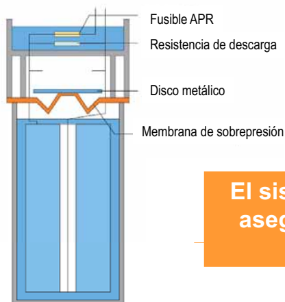
Corte transversal VARPLUS 2 Sistema protección HQ
