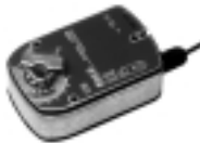
M-LF24, M-LF230. Actuadores todo/nada para compuertas con muelle de retorno, actuación de 4 Nm (3 ft-lbf)
