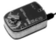
M-LF24-SR. Actuador proporcional 0-10 V para compuertas, actuación de 4 Nm (3 ft-lbf)
