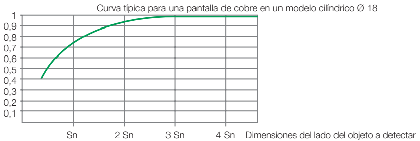
Fig. J10-059: característica de corrección en función de las dimensiones del cuerpo a detectar (Kd).
