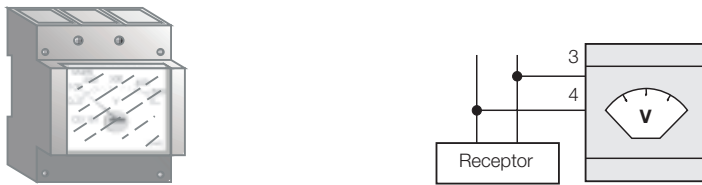
Fig. J11-007: esquema de conexionado del voltímetro VLT.
