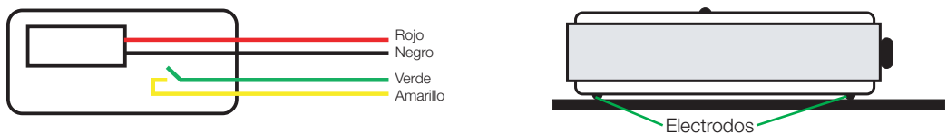
Fig. J19-055: esquema de conexionado y forma de posicionado del DTA-925.
