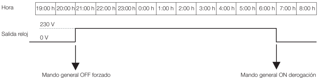
Fig. J19-022: ejemplo de programación del apagado automático de la iluminación sin posible reencendido.
