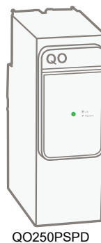
Figure / Figura 5: Whole-Home Surge Protective Device / Dispositivo de protección contra sobretensiones para toda la casa
