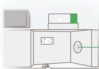
Portable Generator Cord Opening and Inlet / Abertura para el cable y entrada del generador portátil
