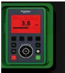
Défaut détecté : le rétroéclairage rouge de l'écran s'active automatiquement.
