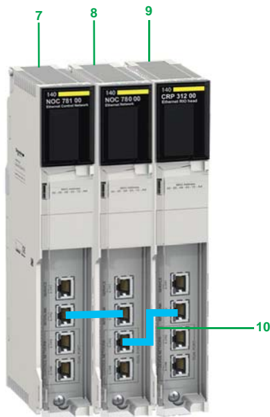
Exemple d'association coupleurs NOC et CRP : 140NOC78100/140NOC78000/140CRP31200
