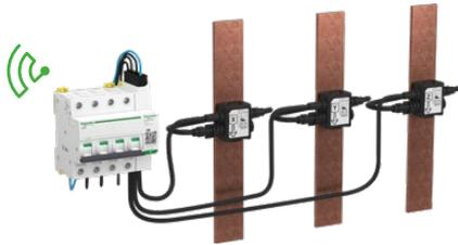
PowerTag Rope ist ein drahtloser per Funk kommunizierender Energiezähler zur Messung bis zu 2000 A in 3P- oder 3P+N-Netzen. Mit seinen flexiblen Rogowski Stromwandlern kann der PowerTag Rope einfach an Sammelschienen und Kabeln installiert werden, ohne dass die Leiter abgeklemmt werden müssen. Die steckbare Federzugklemme für die notwendigen Spannungsabgriffe erleichtert außerdem die Installation.
