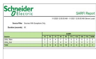
**SAFRI:** zeigt die Anzahl der Spannungseinbrüche und/oder Spannungsüberhöhungen für die ausgewählten Quellen basierend auf den SARFI-Indizes an(SAFRI-X/ SAFRI).
