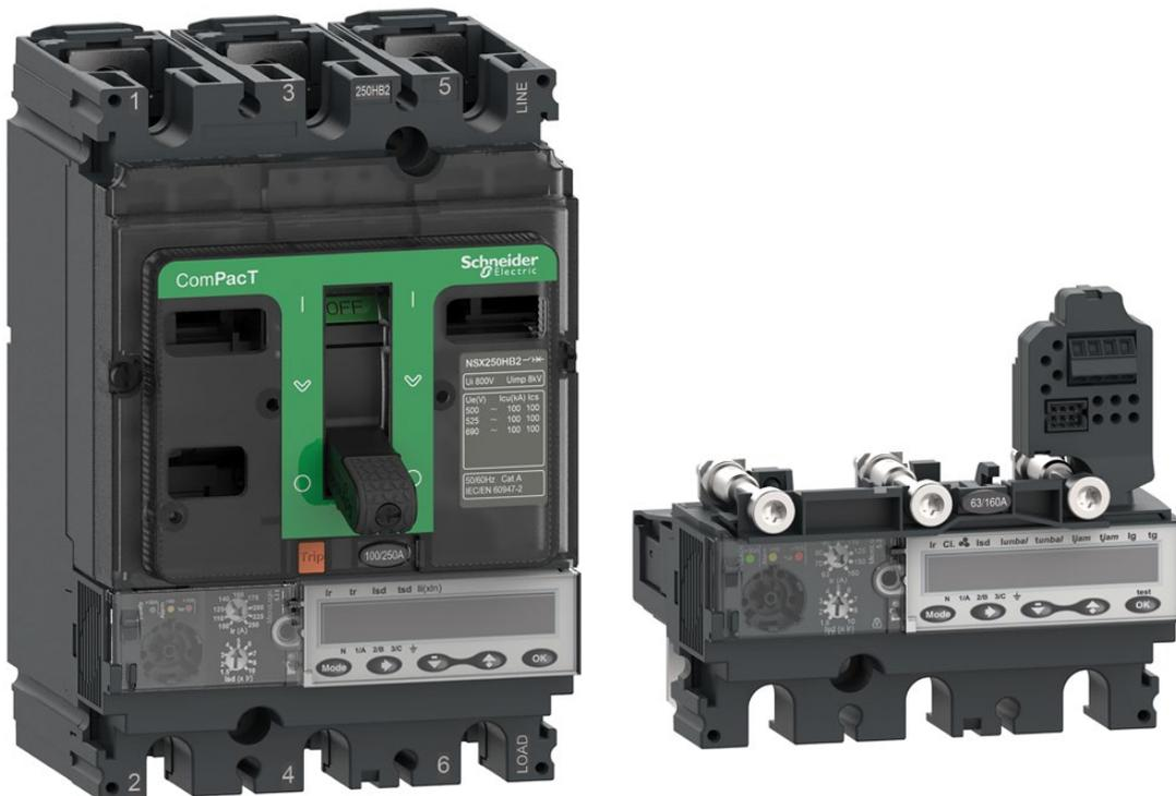
Der ComPacT NSX mit seinen integrierten Stromwandlern, der über einen Mikroprozessor, der unabhängig von den Schutzfunktionen funktioniert, und eine Micrologic 5 / 6 / 7 E bedient wird, ist ein PMD-DD Leistungsmessgerät, das IEC/EN 61557-12, Klasse 0,5 für Spannung, Klasse 1 für Strom und Klasse 2 für Wirkleistungs- und Wirkenergiemessungen erfüllt.
