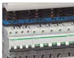
80 A Multiclip. A Multiclip elosztóblokk könnyen rápatintható a sínek hátuljára. Minden típusú moduláris eszköz keverhető ugyanazon sorban, és a fáziskiegyenlítés egyszerű. Könnyen módosítható vagy hozzáadható eszköz.
