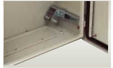
安装板支撑可调, 调节孔 \varnothing 4\text{mm} , 间距 12.5mm 安装设备。
