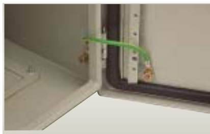
机箱和门用 M6x15 螺栓接地。
