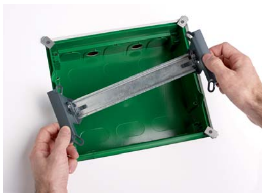
Chassi removível que permite a montagem dos dispositivos fora do quadro e oferece também ajuste para um bom posicionamento horizontal e vertical (versão de embutir)
