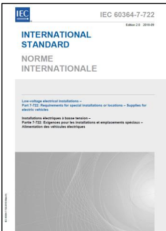
IEC 60364-7-722 ed. 2.0 publicada en 2018 es la norma de referencia para la carga de vehículos eléctricos
