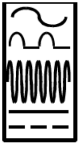
Símbolo de RCD tipo B, conforme a IEC 60755
