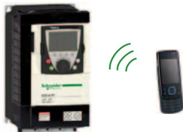
Configurazione con il software SoMove Mobile per telefoni cellulari via Bluetooth®
