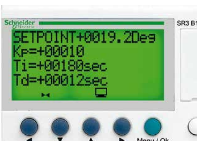
Modifica dei parametri (Kp, Ti, Td) utilizzando programmazione e pulsanti di impostazione parametri
