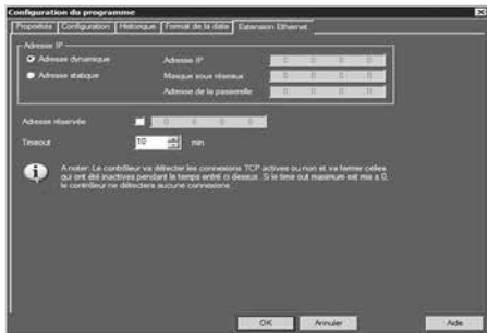
Finestra di configurazione modulo Ethernet
