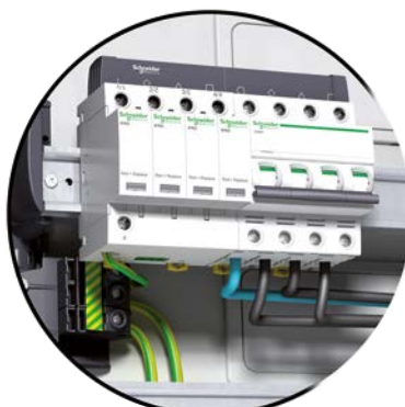
Limitatore di sovratensione iPRD 4P + iC60N 4P per sistema TN-C, TN-S o IT 230 V (L-L) con neutro, (arrivo dal basso con pettine di collegamento)
