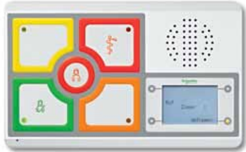
Szolgálati helységi (nővérszobai) modul hívó-nyugtázógombbal és kijelzővel, valamint beszédfunkcióval
