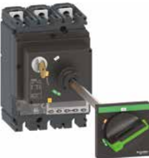
ComPacT avec une poignée rotative étendue installée à l'arrière d'un tableau, avec l'option de verrou à clé et une clé.
