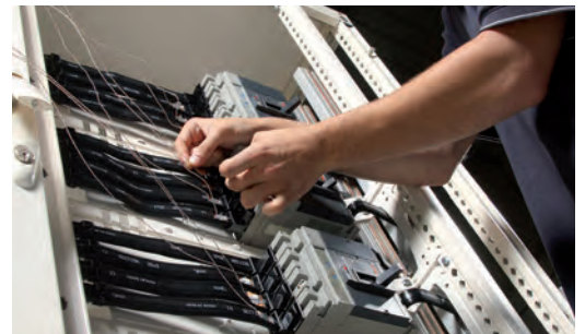
Test d'échauffement en laboratoire.
