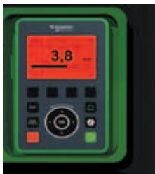
Автоматическая засветка дисплея красным светом при появлении аварийного сообщения
