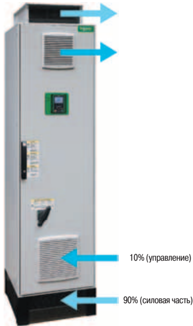
Система охлаждения с разделением потоков воздуха
