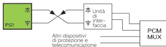
b) Link multiplex - relè collegato a un multiplexer PCM remoto tramite fibra ottica e unità di interfaccia
