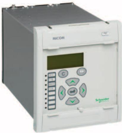
Il relè MiCOM P521 fornisce la protezione differenziale bidirezionale ad alta velocità delle linee aeree e dei cavi interrati in applicazioni quali reti ad anello e partenze in parallelo. L'integrazione di diverse funzioni di protezione ne consente l'applicazione in un'ampia serie di sistemi di alimentazione, garantendo protezione di backup a livello sia locale che remoto.
