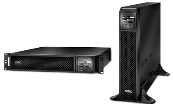
今回販売を開始する「SecureUPS」は、生産現場で求められる常時インバーター方式を採用しています。万が一の停電の際にも無瞬断で接続機器への電力供給が可能です。また、幅広い温度・湿度にも対応し、オフィスに比べてほこりや工作機械の切削粉などが多い工場などにも設置可能な「汚染度 3」に対応しています。このため、駅の券売機や運行管理用設備、自動改札機などへの設置にも適しています。さらに、拡張バッテリーを 10 台まで搭載することができます。これらの機能に加え、業界最高水準の力率 0.9 を実現し、より多くの機器との接続が可能、価格的にも競争力ある製品です。
