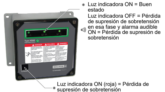
Figura 13: Diagnóstico de funcionamiento
