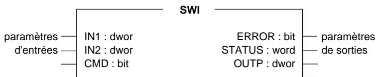
L'OFB SWI commute l'une ou l'autre des 2 grandeurs analogiques d'entrées IN1 et IN2 vers la sortie OUTP; ceci en fonction de l'état du bit de commande CMD :
