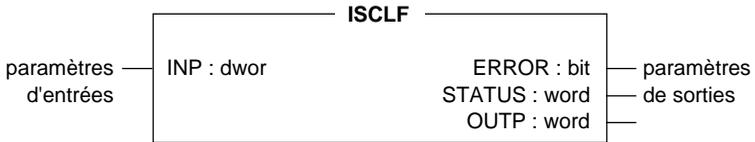
L'OFB ISCLF effectue la conversion d'une grandeur analogique flottante (issue de l'algorithme de régulation) en une valeur entière (destinée en général à un coupleur de sortie analogique).
