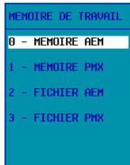
L'utilisation de la mémoire AEM n'est possible que si l'on a préalablement transféré en mémoire automate un fichier configuration STATION.APP, contenant au minimum la configuration des entrées/sorties effectuée sous XTEL-CONF. L'automate peut être en STOP ou en RUN.
