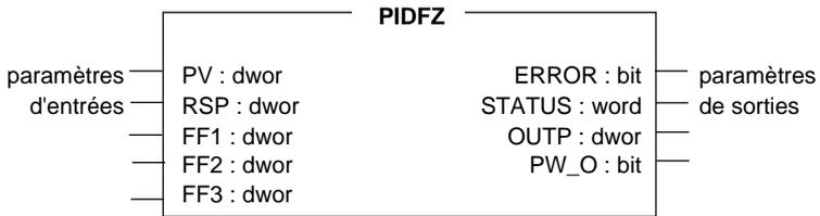
L'OFB PIDFZ est un correcteur PID augmenté d'un feed-forward adaptatif.
