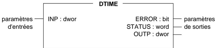
L'OFB DTIME introduit un retard dans la transmission de la grandeur analogique d'entrée INP. La grandeur analogique de sortie OUTP reproduit le comportement de la grandeur analogique d'entrée avec un retard programmé TIME (en secondes).
