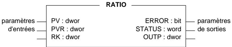
Une régulation de rapport a pour but d'asservir une mesure PV (grandeur réglée) à une autre mesure PVR (grandeur pilote), suivant une formule du type :  $PV = (K \times PVR) + C$ . L'OFB RATIO, utilisé en conjonction avec un correcteur PIDF, permet de réaliser de telles régulations. Il compare également le rapport effectif avec le rapport désiré et positionne les alarmes éventuelles.
