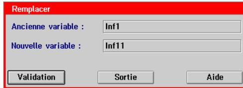
Si la variable à remplacer est associée à un symbole, toutes les utilisations du symbole et du repère associé seront remplacées par la nouvelle variable (par exemple, W34 est associé au symbole Vanne08; toutes les utilisations du repère W34 et du symbole Vanne08 seront remplacées par la nouvelle donnée qui peut être un repère ou un symbole).
