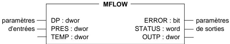
L'OFB MFLOW (correcteur de débit massique) calcule le débit massique d'un gaz dans un élément déprimogène, à partir de la pression différentielle et des conditions de température et de pression du gaz, suivant la formule :
