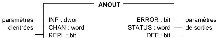
L'OFB ANOUT est l'interface langage des sorties analogiques utilisées dans des boucles de régulation et programmées avec PMS2.
