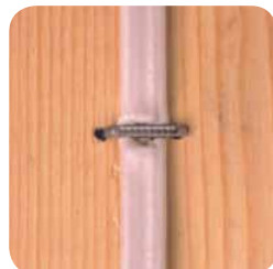
Câble transpercé par un clou ou une agrafe
