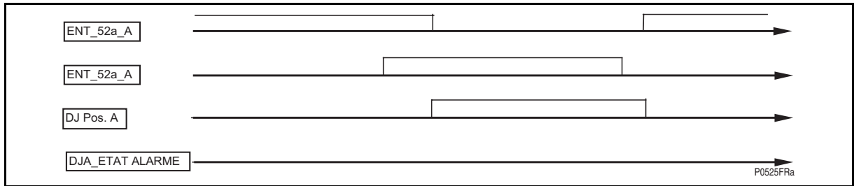
FIGURE 126 - DISCORDANCE 52A/52B TROP BREVE POUR DECLENCHER L'ALARME
