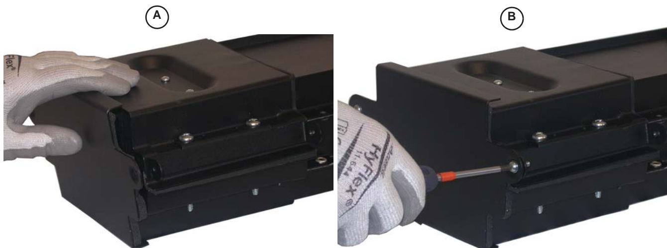
Figure 17 : Installation des plaques de fermeture
