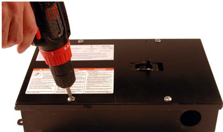
Figure 5 : Fixation du couvercle de l'unité enfichable
