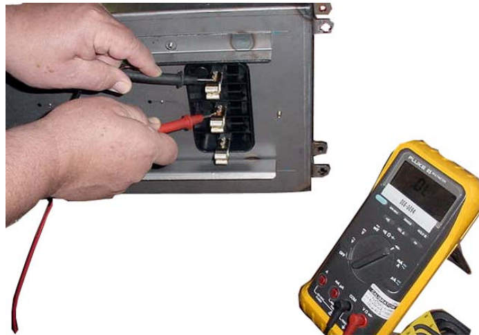
Figure 7 : Essai de résistance d'isolation de l'unité enfichable avant l'installation
