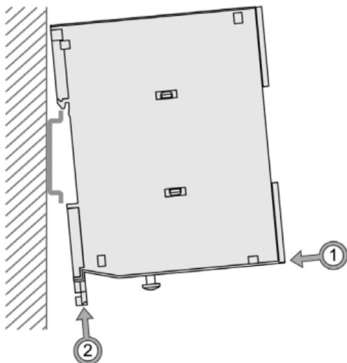
TwidoPort est généralement monté sur un rail DIN ou sur un panneau à l'aide du kit de montage Twido (TWDXMT5) correspondant.
