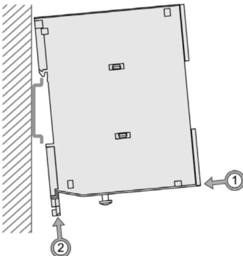
Normalerweise wird TwidoPort an einer DIN-Schiene oder mittels des Twido-Schalttafel-Montagesatzes (TWDXMT5) an einer Schalttafel montiert.
