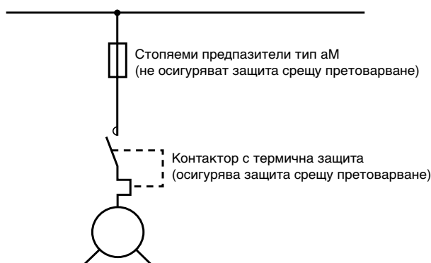
Фиг. G40: Верига, защитена със стопяеми предпазители тип aM
