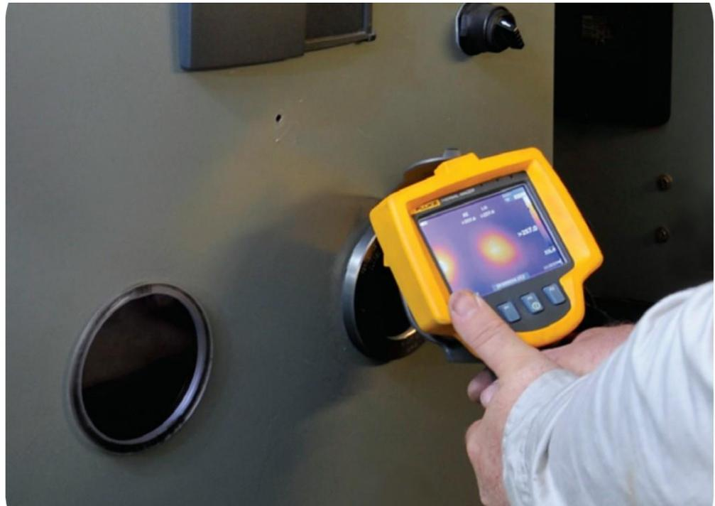
Généralement, la thermographie infrarouge nécessite également une fenêtre infrarouge installée dans la porte de l'appareillage pour fournir un accès adéquat à la caméra afin de tester l'équipement sous tension.
