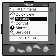
Afficheur FDM121 : navigation.
