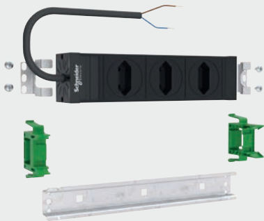
ABNPE303P02 Schutzkontaktsteckdose EURO 3-fach drehbar Media mit 2m Leitung H05VV-F 3G1,5mm 2 und Montagezubehör
