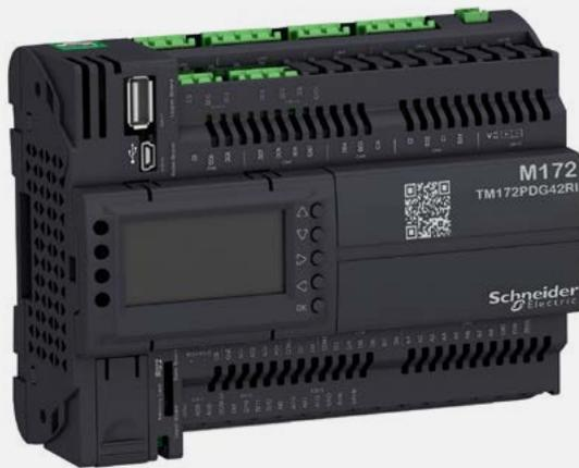
Eine große Auswahl an Kommunikationsschnittstellen und -protokollen wie Ethernet, Modbus, BACnet und LonWorks ermöglichen eine einfache, effiziente und sichere Integration in Gebäudeleitsysteme (GLT) oder die Anbindung an Cloud-Anwendungen und Fernwartungslösungen. Mit der kostenlosen Programmiersoftware EcoStruxure™ Machine Expert - HVAC können Maschinen jetzt noch einfacher und schneller programmiert, visualisiert und in Betrieb genommen werden.
