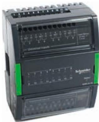
Das UI-16 ist ein E/A-Modul mit 16-Kanal- Universaleingängen. Die Universal-eingänge sind ideal für alle Kombinationen von Temperatur, Druck, Durchfluss, Statusmeldungen und ähnlichen Datenpunkten in einem Gebäudeleitsystem. Die Universal-Eingänge können so konfiguriert werden, dass verschiedene Arten von Eingaben gelesen werden können:
