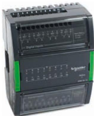
Das DI-16 ist ein E/A-Modul mit 16-Digitaleingängen. Die Digitaleingänge können zur kostengünstigen Erfassung mehrerer potentialfreier Digitaleingänge in Anwendungen, wie etwa der Gerätestatusüberwachung oder Alarmpunktüberwachung, verwendet werden. Als Zählereingänge werden Digitaleingänge häufig in Energiemessanwendungen genutzt.
