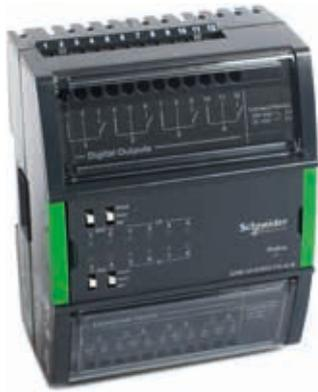
Das UI-8/DO-FC-4 und das UI-8/DO-FC-4-H sind E/A-Module mit 8-Kanal-Universaleingängen und 4-Kanal- Digitalausgängen. Die Universaleingänge sind ideal für alle Kombinationen von Temperatur, Druck, Durchfluss, Statusmeldungen und ähnlichen Datenpunkten in einem Gebäudeleitsystem. Die Universal-Eingänge können so konfiguriert werden, dass verschiedene Arten von Eingaben gelesen werden können:
