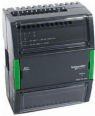
Das Spannungsversorgungsmodul PS-24V wurde konzipiert, um die spezifischen Anforderungen des SmartX AS-P Servers und seinen verbundenen E/A-Modulen zu erfüllen. Das PS-24V ist ein Spannungsversorgungsmodul, das für eine Eingangsspannung von 24 V AC oder DC geeignet ist.
