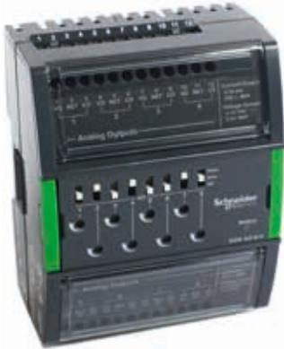
Das AO-8 und das AO-8-H sind E/A-Module mit 8-Kanal-Analogausgängen. Jeder Analogausgang kann als Spannungs- oder Stromausgang konfiguriert werden. Daher unterstützen Analogausgänge eine Vielzahl von Geräten, wie zum Beispiel Aktoren.
