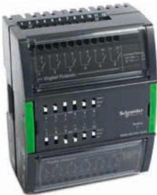
Das DO-FA-12 und das DO-FA-12-H sind E/A-Module mit 12-Kanal-Digitalausgängen. Es handelt sich um Digitalausgänge der Form A. Die Form A Relais (Schließer) sind für das direkte Schalten von Lasten angelegt
