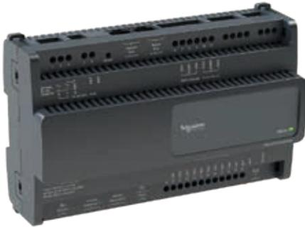
Der SmartX RP-C ist eine frei programmierbare, BACnet/IP-basierte Raumautomationsstation mit integrierten Ein- und Ausgängen zur Regelung und Überwachung einer breiten Palette an HLK-Anwendungen. Dabei kann der RP-C entweder als ein alleinstandender BACnet/IP-Feldcontroller oder als Teil eines EcoStruxure GA-Systems mit übergeordnetem Server (AS-P, AS-B oder Enterprise Server) verwendet werden.
