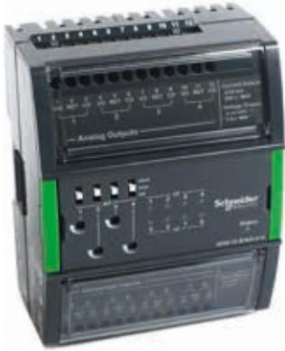
Das UI-8/AO-4 und das UI-8/AO-4-H sind E/A-Module mit 8-Kanal-Universaleingängen und 4-Kanal-Analogausgängen. Die Universaleingänge sind ideal für alle Kombinationen von Temperatur, Druck, Durchfluss, Statusmeldungen und ähnlichen Datenpunkten in einem Gebäudeleitsystem. Die Universal-Eingänge können so konfiguriert werden, dass verschiedene Arten von Eingaben gelesen werden können:
