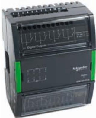
Das DO-FC-8 und das DO-FC-8-H sind E/A-Module mit 8-Kanal-Digitalausgängen. Die Digitalausgänge unterstützen digitale Form C Punktarten. Die Form C Relais (Wechsler) sind für Applikationen mit einer direkten Ausgangsbelastung ausgelegt.
