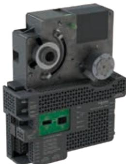
Der SmartX MP-V ist ein frei programmierbarer, BACnet/IP-basierter Volumenstromregler mit integriertem Klappenantrieb, Luftstromsensor und wahlweise 7 oder 9 Ein-/Ausgängen. Dabei können die MP-V entweder als alleinstehender BACnet/IP-Feldcontroller oder als Teil eines EcoStruxure GA-Systems mit übergeordnetem Server (AS-P, AS-B oder Enterprise Server) verwendet werden.
