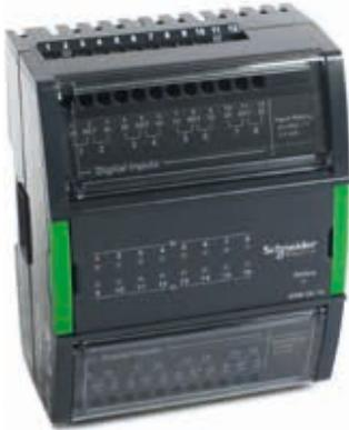
Das RTD-DI-16 ist ein 16-Kanal-E/A-Modul mit RTD- /Digitaleingängen. Die Eingänge des E/A-Moduls RTD-DI-16 sind zum Lesen von sieben verschiedenen Arten von Eingaben konzipiert:
