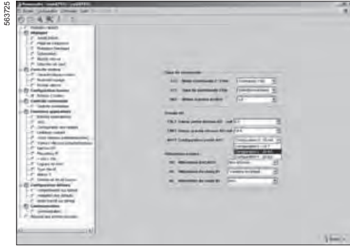
Konfiguration der Ausgänge AOC/AOV mit PowerSuite für PC
