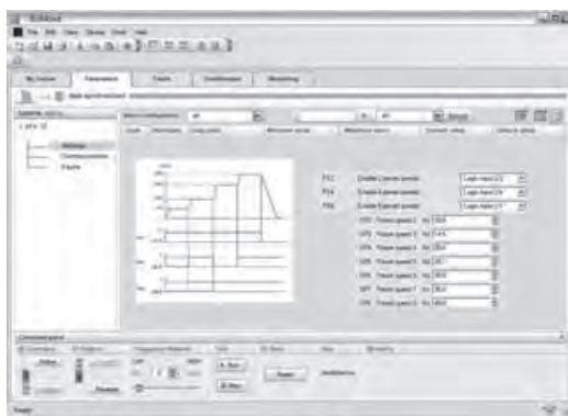
Einstellen der Vorwahlfrequenzen mit der Inbetriebnahmesoftware SoMove
