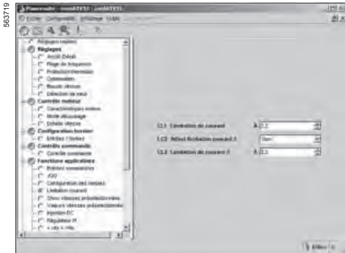
Konfiguration der Umschaltung der Strombegrenzung mit PowerSuite für PC
