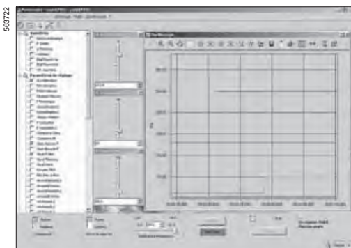
Überwachung der verschiedenen Parameter mit der Oszilloskop-Funktion von PowerSuite für PC
