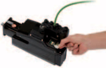
Duplizieren einer Applikation mit der Speicherkarte VW3M8705
