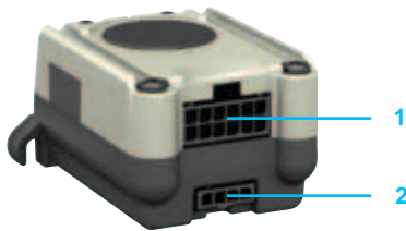
SD215DU20C-Schrittmotorverstärker mit Puls/Richtung-Schnittstelle
