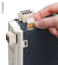
Duplizieren einer Applikation mit der Speicherkarte VW3M8705
