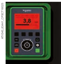
Ermittelte Störung: roter Hintergrund des Displays wird automatisch aktiviert
